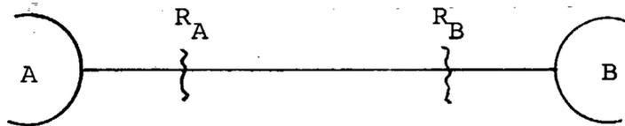
Fig. 8. Energibånd (stregen) med signalindices (de to krøllede mærker) og signalsymboler (" $R_A$ " og " $R_B$ "), som forbinder to systemkomponenter A og B (halvcirklerne). Sml. fig.6.
