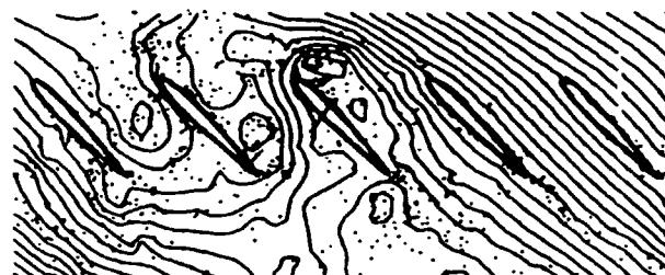
**Figur 1.6:** Turbulens imellem rotorenens blade medfører, at der kommer en stallcelle, dvs. en “prop” hvor der ikke kan trænge luft igennem. Til højre ses jævn strømning og til venstre ses en stall-celle. [Spa.84]
